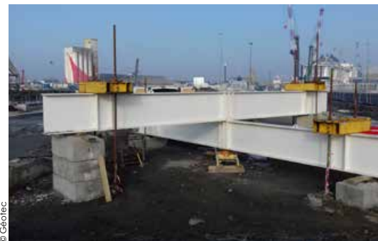
Essai de compression de 2 500 kN sur inclusions rigides.
