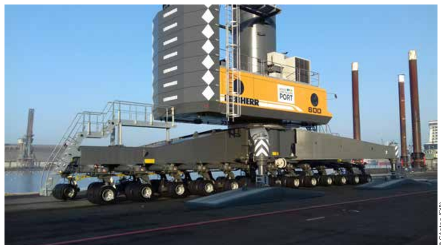
Nouvelle grue mobile portuaire Liebherr LHM600 (poids à vide 5 400 kN, capacité de levage de 2 000 kN) acheminée par bateau, le 10 décembre 2020, et déchargée au droit du bassin de Penhoët, à proximité de la forme Joubert.
