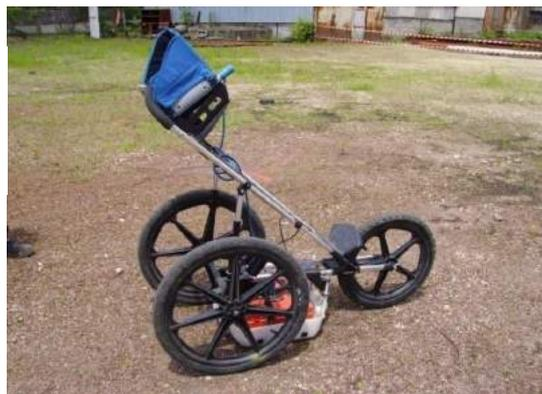
Matériel de mesure radar : SIR4000 et antenne 200 MHz avec roue codeuse.
