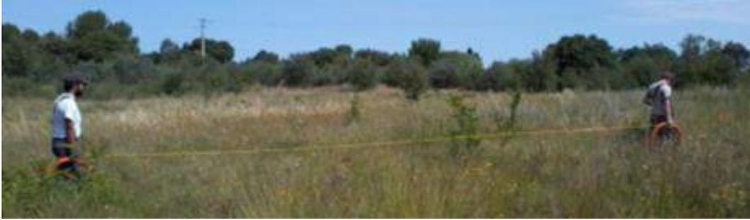
Photographie 1 – EM34 en mode dipôle horizontal, espacement inter-bobines de 10m.
