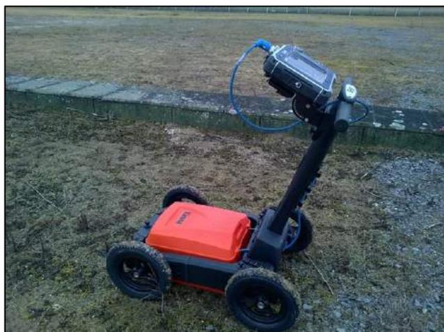
Matériel de mesure radar : SIR 4000 et antenne bi-fréquences 300 MHz/800 MHz avec roue codeuse.
