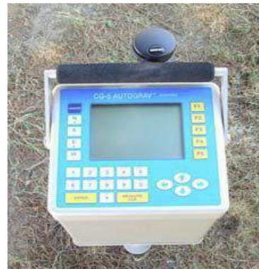
Photographies 1 et 2 : Gravimètre SCINTREX CG5 Autograv
