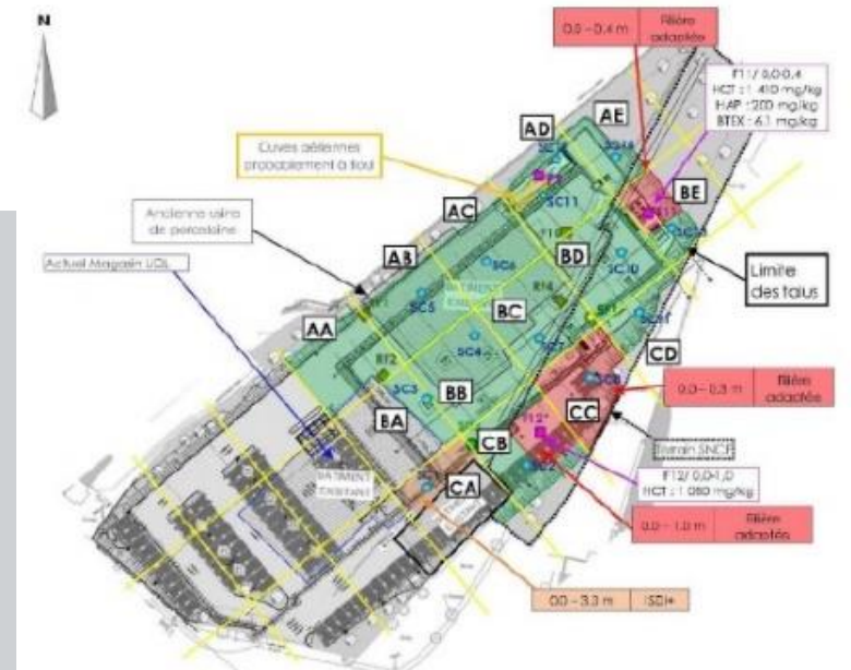
Plan de terrassement 0.4 à 1.0 m de profondeur / terrain actuel
