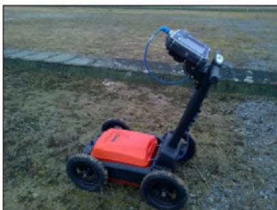
SIR 4000 et antenne bi-fréquences
